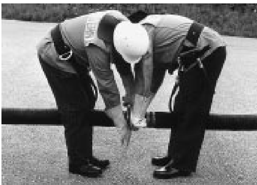
Die Saugschläuche werden zwischen den Beinen festgehalten. Die Kupplungen werden von Hand vorgekuppelt. Durch Rechtsdrehen fassen die Knaggen und werden mit dem Kupplungsschlüssel nachgezogen.
